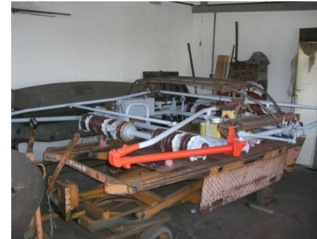
Der Pantograph der E16 wird restauriert
