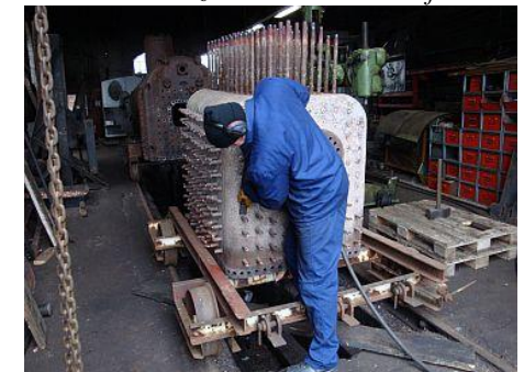
Die Stehbolzenreste werden entfernt
