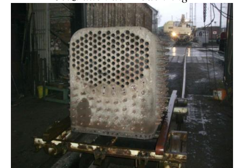
Die Stehbolzenreste werden entfernt
