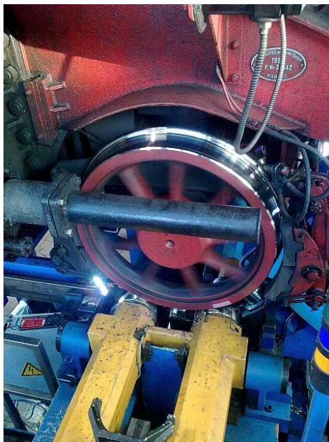
23 042 beim der Einfahrt auf die Unterflurdrehbank und Abdrehen der Vorlaufräder.
